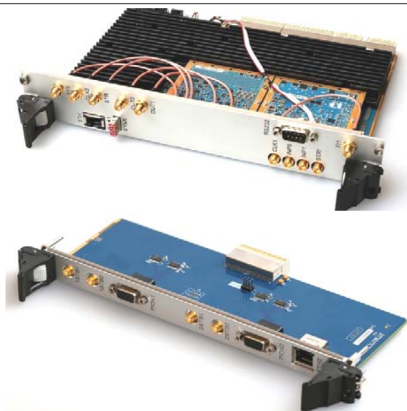
Рис. 7. Внешний вид модернизированных модулей цифровой обработки радиолокационных сигналов (вверху) и нового тыльного модуля (внизу), разработанных для новой РСА
