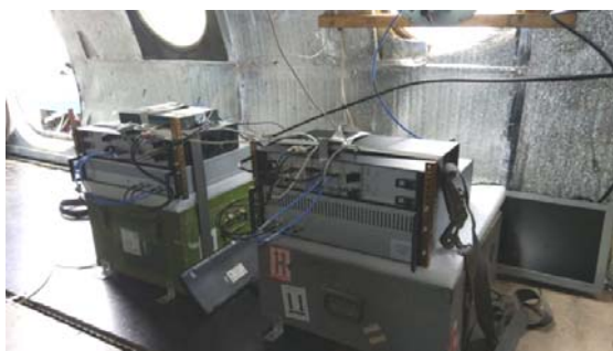
Рис. 8. Приемопередатчики и бортовые управляющие ЭВМ обоих диапазонов (вверху) и антенна X-диапазона (внизу) на борту летающей лаборатории
