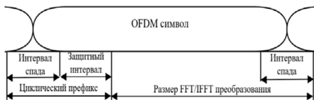
Рис. 4. Структура OFDM-символа IEEE 1901.1 стандарта
