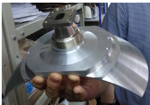
Рис. 2. Конструкция антенны X-диапазона: вид со стороны апертуры (вверху), вид с обратной стороны (внизу)
