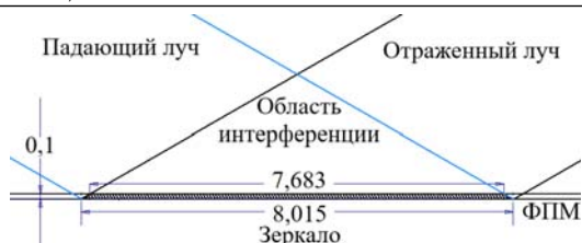
Рис. 4. Распространение лучей при записи под углом в 60^\circ
