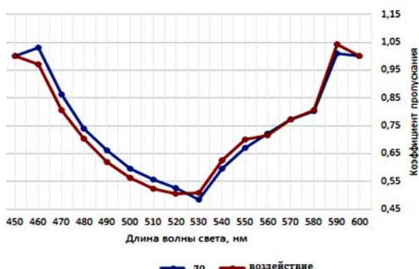
Рис. 2. Спектральные характеристики коэффициента пропускания slave2-образца до и после воздействия света на master-образец и электрического поля на slave1-образец
