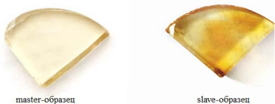
Рис. 5. Окрашенность master- и slave-образца при измерении электропроводности при воздействии солнечного света на master-образец
