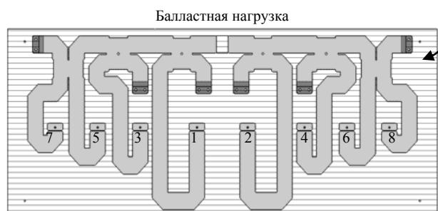
Рис. 5. Сечение 3D-модели 8-канального волноводного неравновесного делителя
