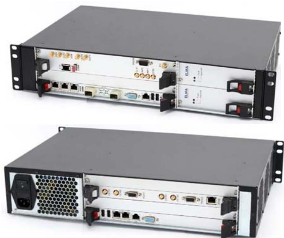
Рис. 6. Внешний вид бортовой ЭВМ с установленными модулями цифровой обработки сигналов
