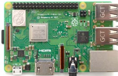
Рис. 1. Raspberry Pi 3 Model B+
