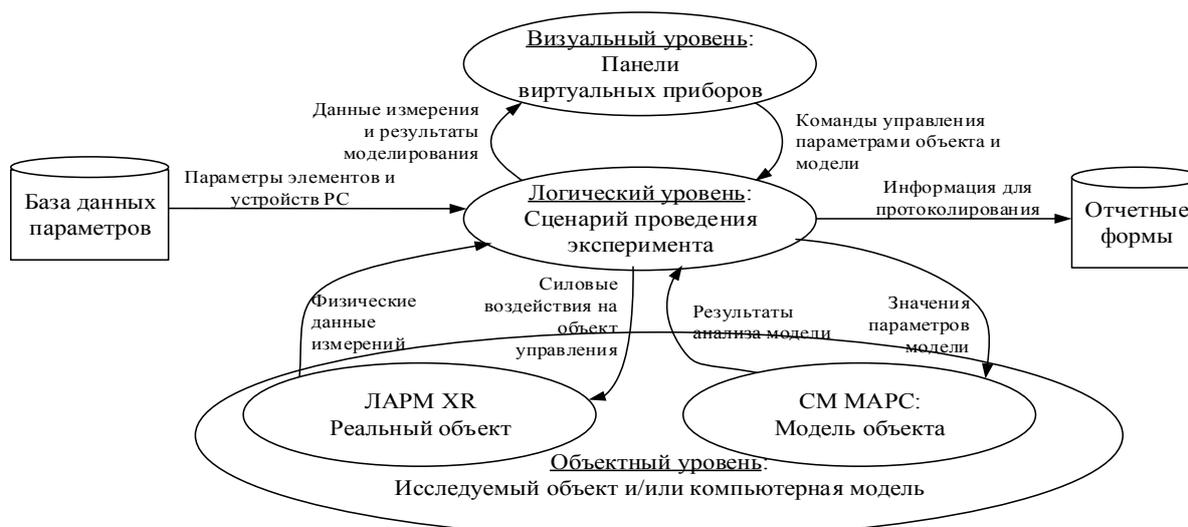
Рис. 2. Многоуровневая компьютерная модель панелей виртуальных приборов
