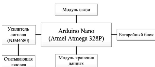
Рис. 3. Обобщенная схема прототипа устройства
