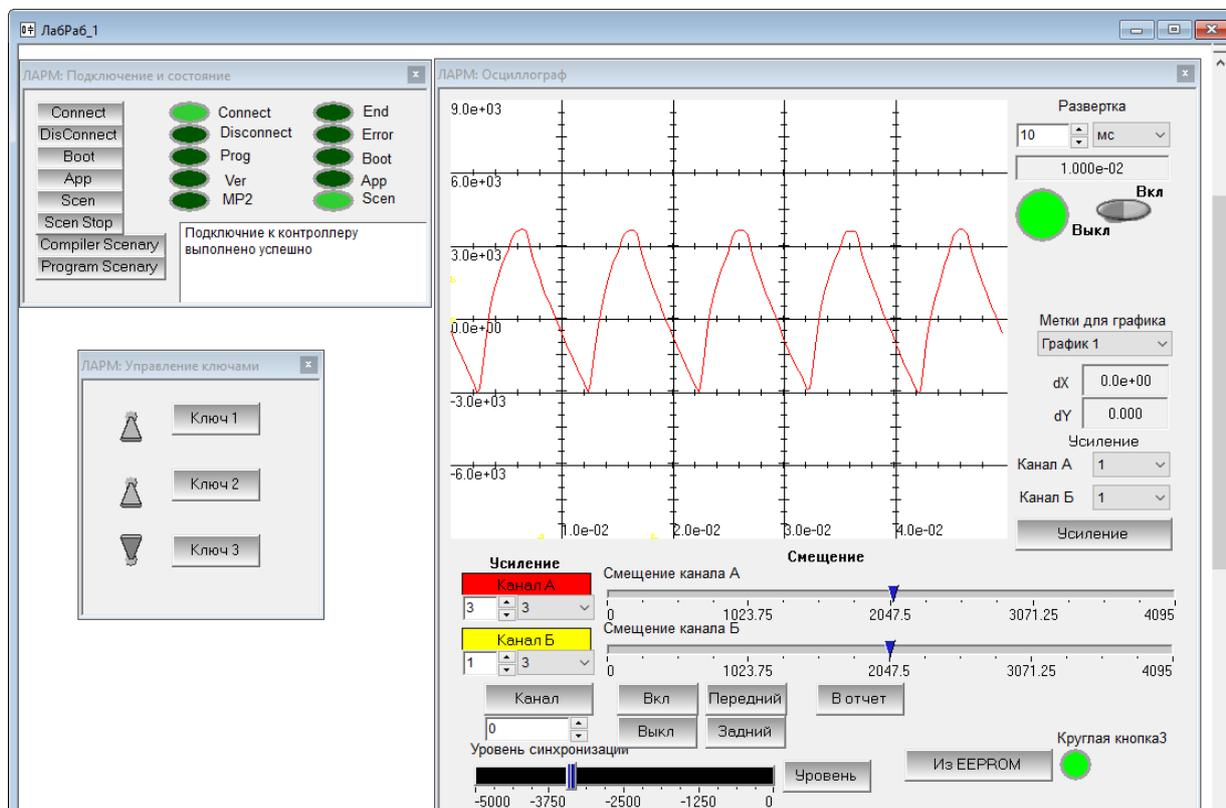
Рис. 3. Лицевая панель для проведения лабораторной работы по исследованию источника вторичного электропитания
