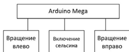
Рис. 6. Структурная схема взаимодействия центрального и силового блоков
