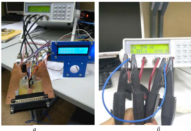
Рис. 3. Макет устройства для теста и анализа кабеля: a – измерение через коммутатор; б – прямое измерение
