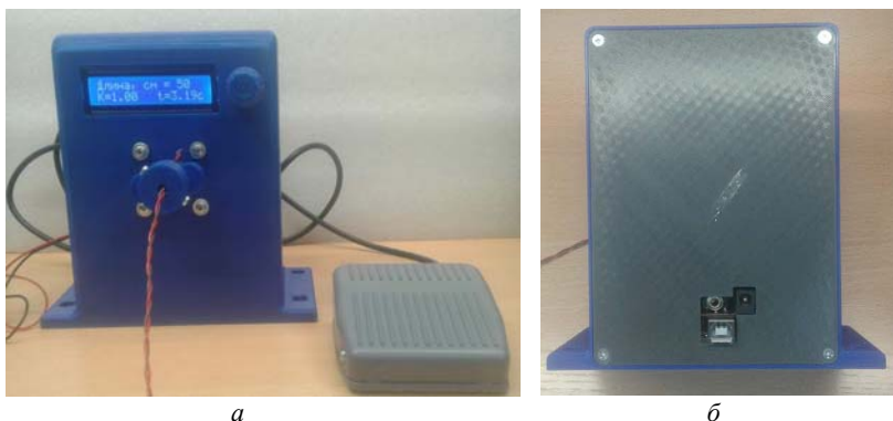
Рис. 4. Сборочный вид устройства для скручивания проводов: а – вид спереди, б – вид сзади
