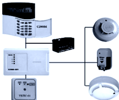
Рис. 1. Структурная схема системы пожарной сигнализации с использованием устройства контроля пожарной сигнализации (УКПС-01)
