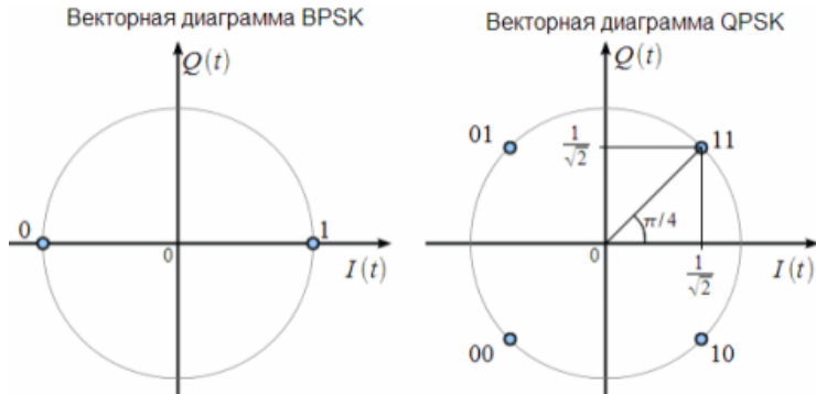
Рис. 1. Векторная диаграмма BPSK и QPSK сигнала
