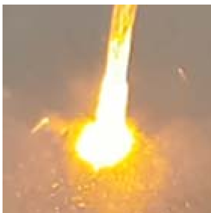
Рис. 2. Разряд между электродами при U = 650 В, I = 0,6 А
