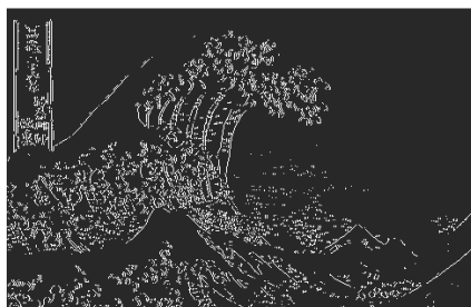
Рис. 2. Извлечение краев с помощью детектора Собела
