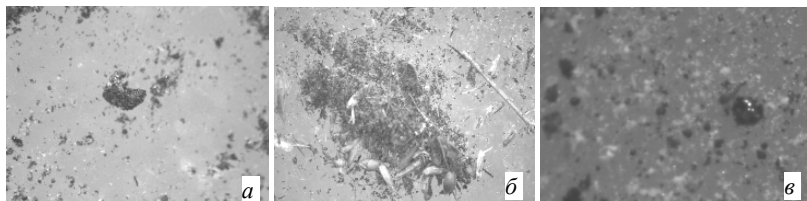
Рис. 1. Результаты исследования проб на бинокулярном микроскопе: а – шлак; б – общий вид пробы; в – металлические микросферы
