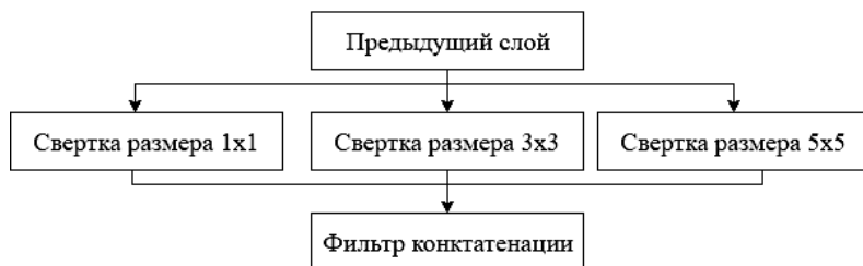
Рис. 1. Архитектура GoogleNet (Inception-v1)
