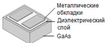
Рис. 1. СВЧ-конденсатор поверхностного монтажа
