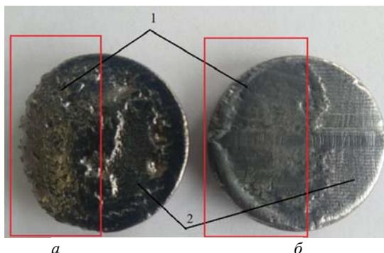
Рис. 2. Образцы после обработки электронным пучком. *a* – образец, обработанный широким пучком (плотность мощности  $250 \text{ Вт/см}^2$ ); *б* – узким сканирующим пучком (плотность мощности  $1 \text{ кВт/см}^2$ ); 1 – область, на которую был нанесен керамический порошок; 2 – область без нанесения керамического порошка
