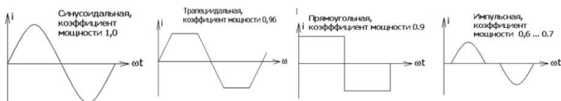
Рис. 1. Зависимость коэффициента мощности от формы тока в схемах без использования ККМ
