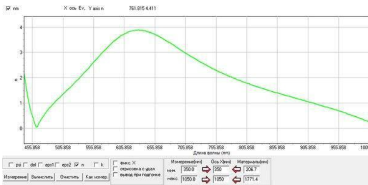
Рисунок 2.6 – Смоделированная зависимость n=f(\lambda) для пленки \text{SiO}_2 на подложке Si
