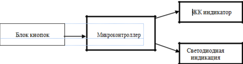
Рис. 2. Структурная схема блока интерфейса управления
