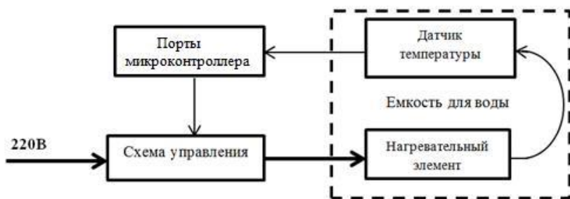
Рис. 3. Структурная схема блока контроля температуры воды.
