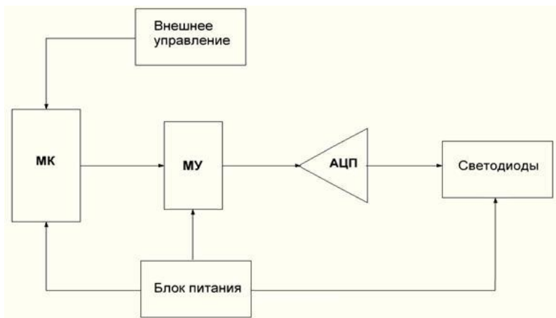
Рис. 8. Структурная схема светодиодной лампы
