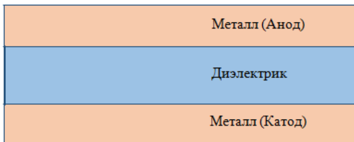
Рисунок 1 – Схематичное представление МДМ-структуры
