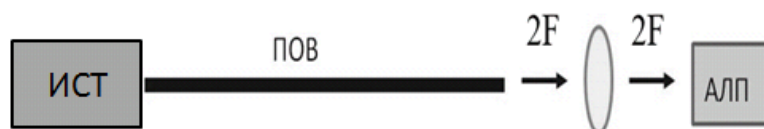
Рис.2- Схема экспериментальной установки для измерения распределения интенсивности света на выходных торцах ПОВ
