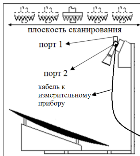
Рис.1 – Схематичное представление исследуемой антенны при измерениях
