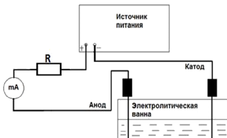
Рис. 1 – Схема экспериментальной установки для анодирования
