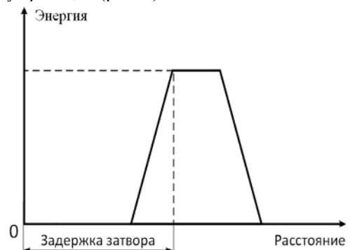
Рис. 2. Активная зона видения для прямоугольных импульсов при \tau_L < \tau_g
