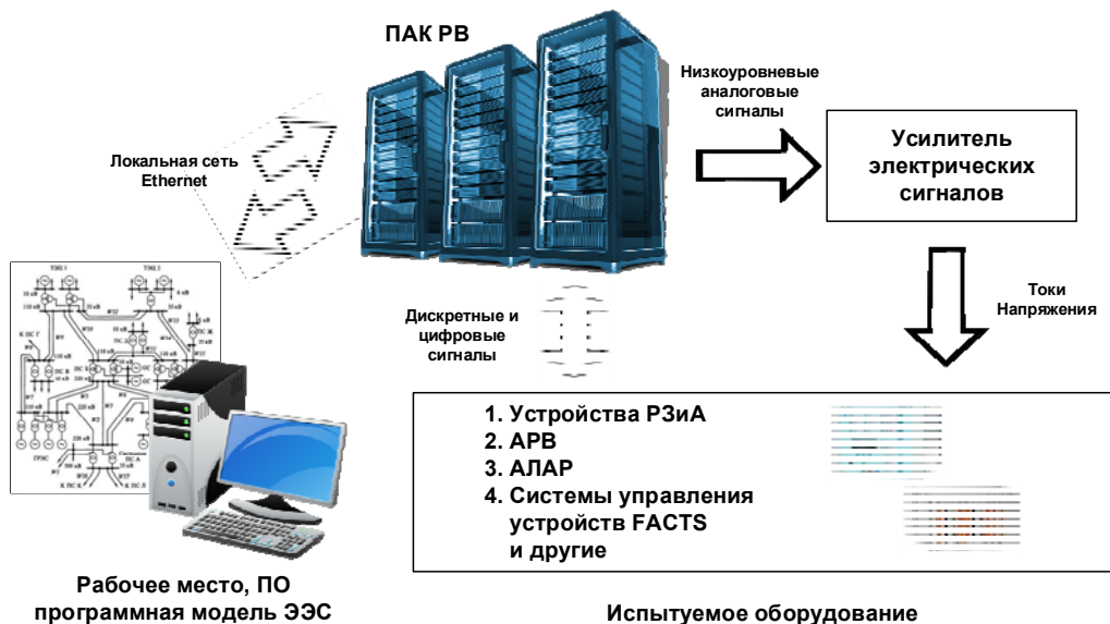
Рис. 1. Структурная схема реализации исследований и испытаний устройств в «замкнутом цикле» с помощью ПАК РВ
