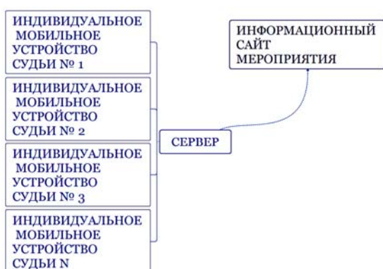
Рис. 1. Структурная схема автоматизированной судейской системы
