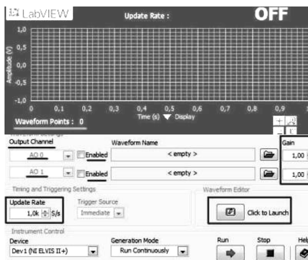
Рис. 5. Лицевая панель генератора сигналов произвольной формы
