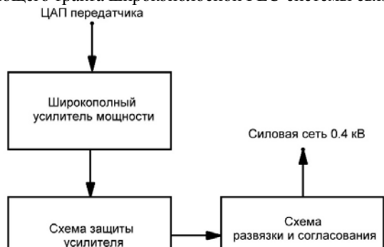
Рис. 3. Структурная схема передающего тракта широкополосной PLC-системы связи
