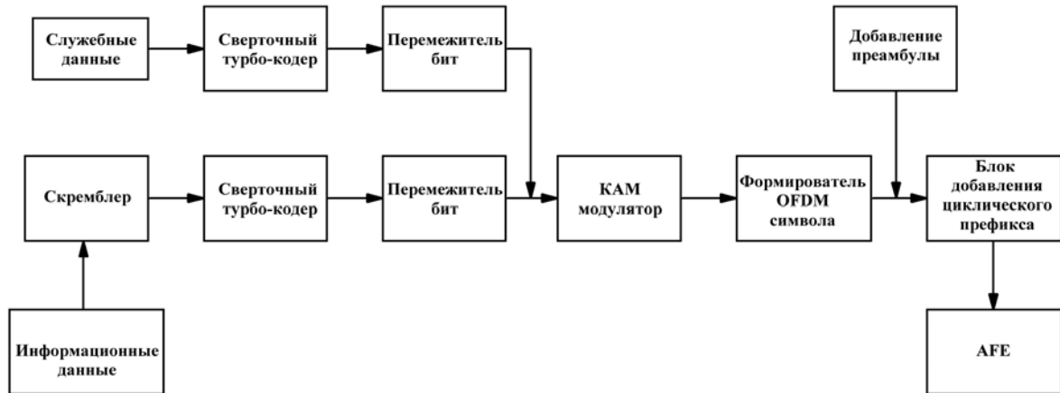
Рис. 1. Блок-схема алгоритма формирования сигнала
