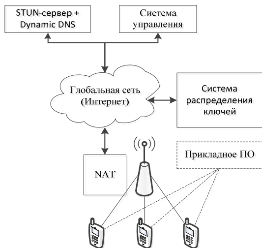
Рис. 1. Типовая структурная схема инфраструктуры сети мобильных устройств
