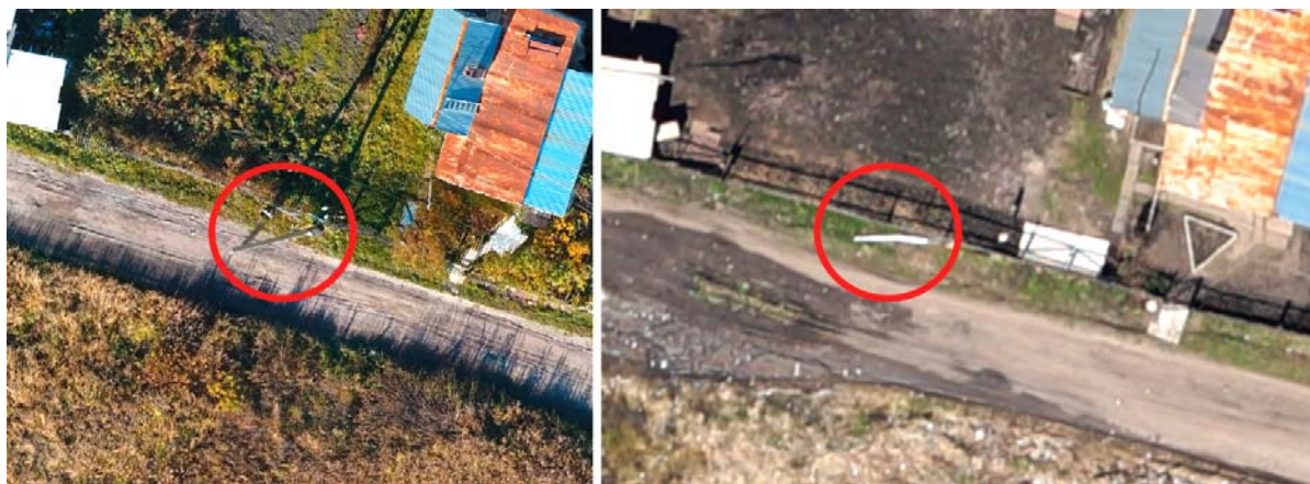
Рис. 6. Изображение опоры ЛЭП с БПЛА вертолетного типа DJI Phantom 4 – а; изображение опоры ЛЭП с БПЛА самолетного типа – б
