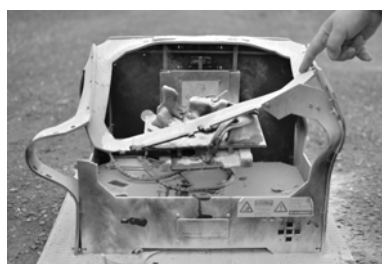
Рис. 4. Принтер, покрытый мелким дисперсионным порошком, после срабатывания «ОСП-1 мини»
