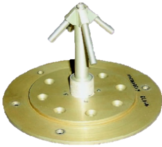
Рис. 1. Фото антенны ТКС КА
