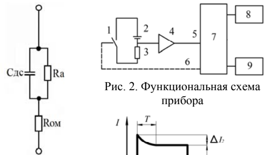
Рис. 1. Эквивалентные схемы замещения сопротивления ХИТ: R_a – сопротивление электрохимической реакции; R_{ом} – омическая составляющая; C_{дс} – емкостная составляющая полного сопротивления
