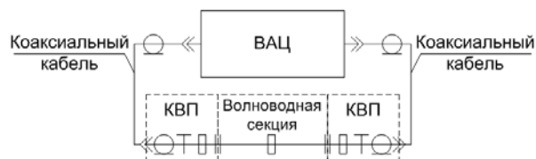
Рис. 1. Схема экспериментальной установки
