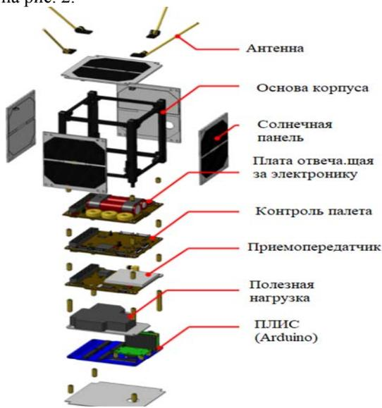
Рис. 2. Компоновка CubeSat 1U
