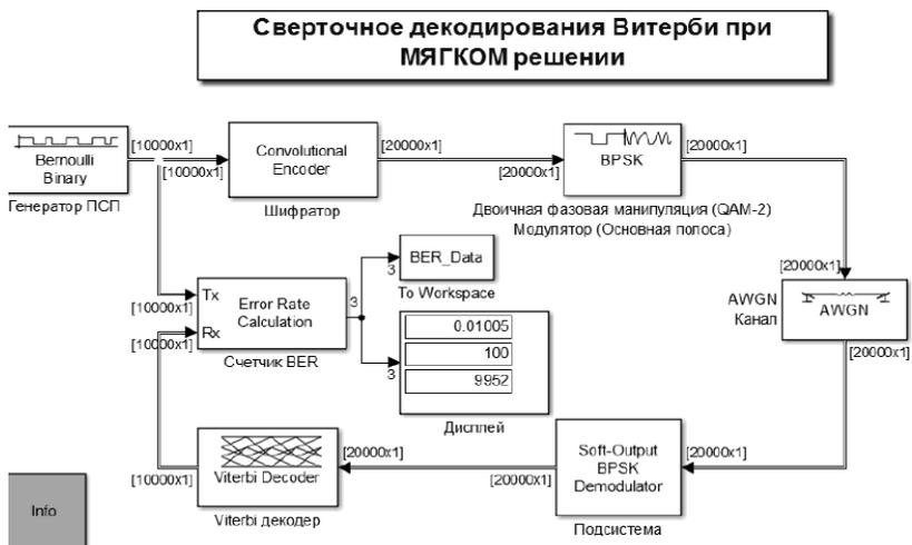
Рис. 6. Модель сверточного декодера Витерби при «мягком решении»
