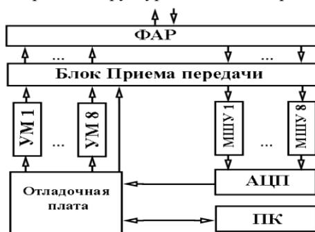
Рис. 1. Структурная схема содара на ФАР
