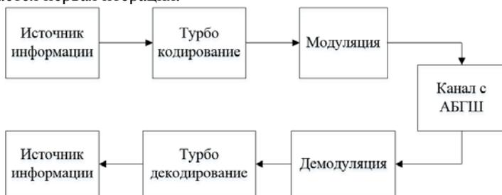
Рис. 3. Кодирование/декодирование и модуляция/демодуляция в канале связи
