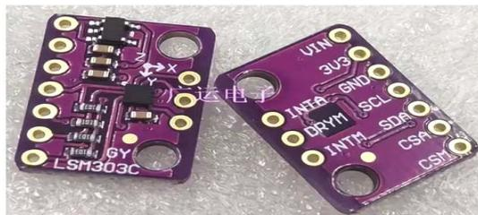
Рис. 1. Общий вид модуля LSM330C с векторным магнитным датчиком
