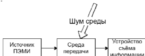
Рис. 1. Функциональная схема канала утечки ПЭМИ
