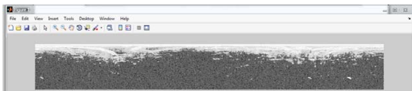
Рис. 4. Гистограммная эквализация изображения после фильтрации функцией Хаара
