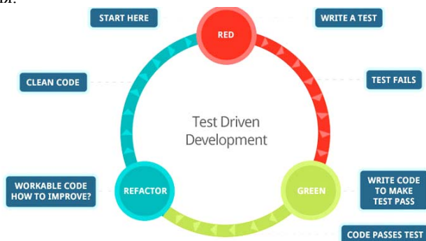
Рис. 1. Стадии разработки через тестирование
