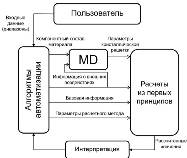
Рис. 1. Структурная схема проведения расчетов
