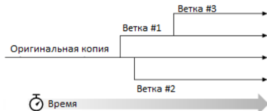
Рис. 1. Ветки в разработке при использовании SVN
