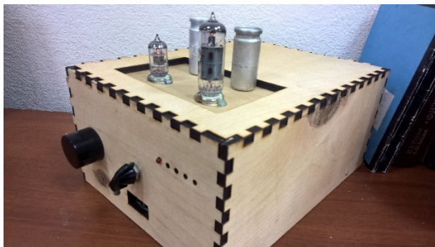
Рис. 1. Прототип лампового mp3-проигрывателя
