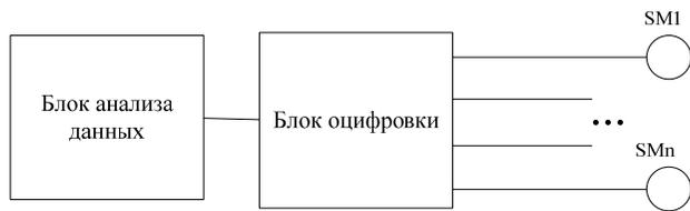
Рис. 1. Схема устройства, где SM1–SMn – микрофоны
