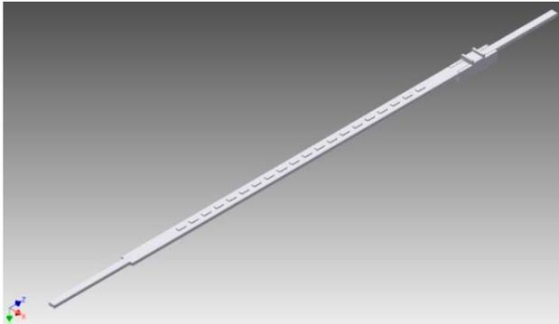
Рис. 1. 3D-модель излучающего элемента ленточной структуры
