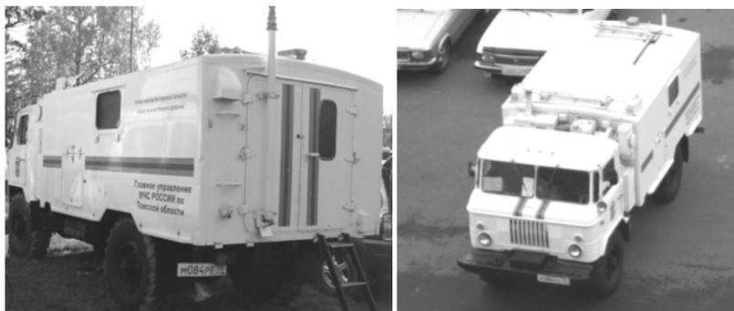
Рис. 1. Командно-штабная машина Р-142Н на базе ГАЗ-66
