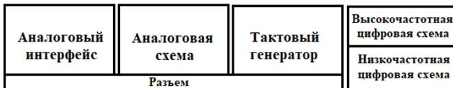
Рис. 2. Расположение аналоговых и цифровых блоков с тактовым генератором на печатной плате [3]
