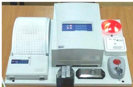
Рис. 2. Лабораторный макет охранной сигнализации с УКТС
