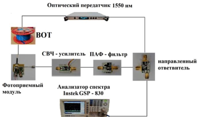
Рис. 2. Схема соединений макета ОЭГ
