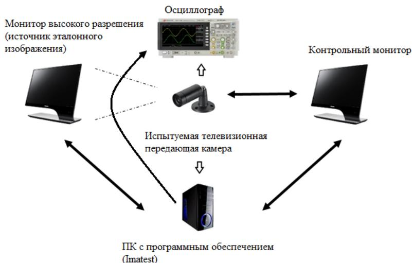
Рис. 3. Структура схема используемого устройства
