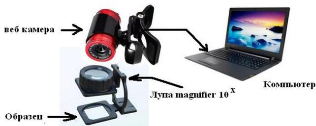
Рис. 1. Схема установки получения изображений поверхностей с помощью веб-камеры и лупы 10× (подсветка – белый свет)
