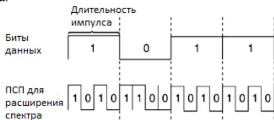
Рис. 1. Применение ПСП для искусственного расширения спектра
