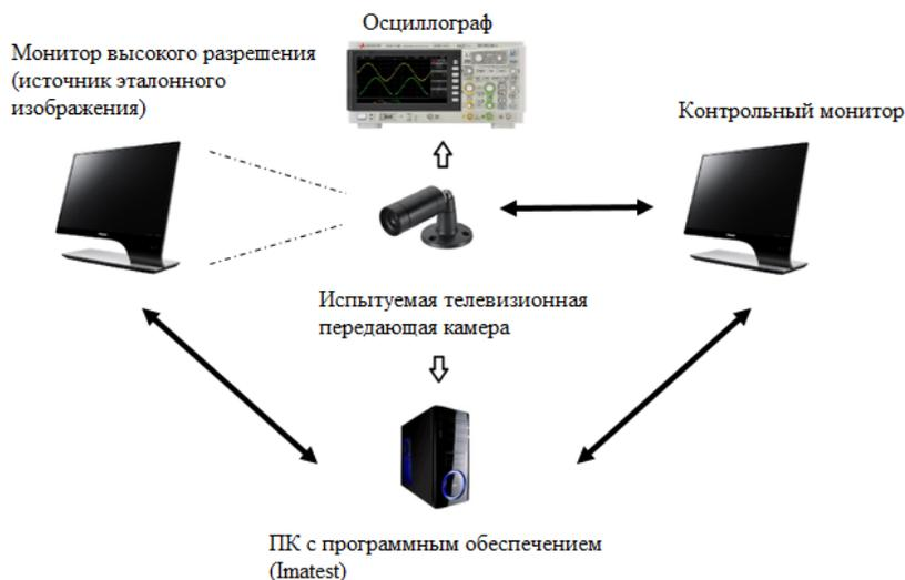
Рис. 2. Структурная схема устройства для измерения спектральных характеристик телевизионных передающих камер
