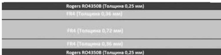
Рис. 2. Слои печатной платы в трехмерной модели
