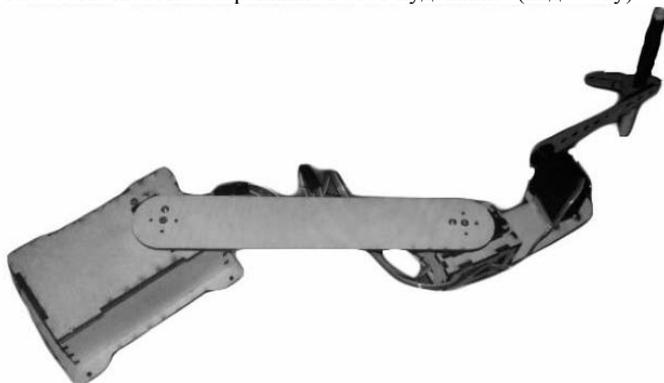
Рис. 4. Полностью собранный «Робот-художник» (вид сверху)
