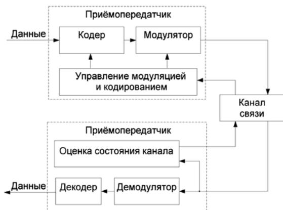
Рис. 1. Структурная схема системы с адаптивной модуляцией и кодированием
