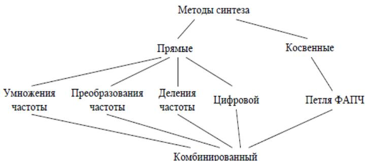
Рис. 1. Классификация методов синтеза
