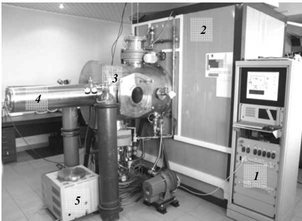
Рис. 1. Фотография экспериментальной установки: 1 – блок управления вакуумной системой и разрядами; 2 – высоковольтный терминал; 3 – вакуумная камера; 4 – времяпролетный спектрометр; 5 – система «безмасляной» откачки
