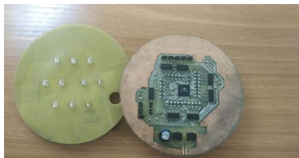
Рис. 3. Макет печатного узла светодиодной лампы
