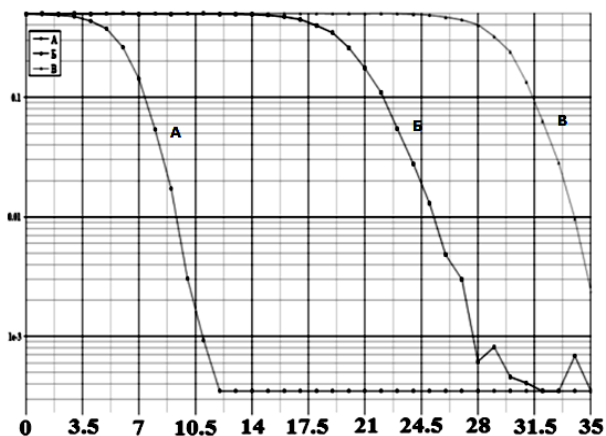
Рис. 9. Зависимость BER от ОСШ: А – первого канала 0,882 Вт; Б – второго канала 0,105 Вт; В – третьего канала 0,012 Вт
