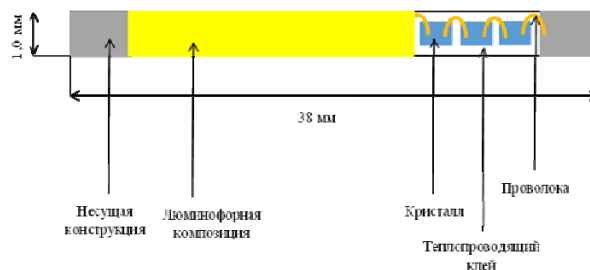
Рис. 2. Конструкция светодиодного излучающего элемента
