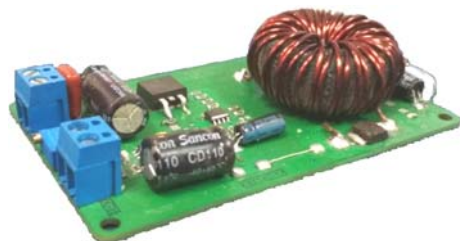
Рис. 4. Печатный узел разрабатываемого блока питания
