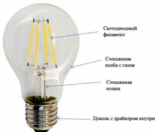
Рис. 1. Конструкция светодиодной лампы
