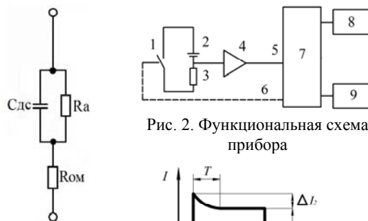
Рис. 1. Эквивалентные схемы замещения сопротивления ХИТ: R_a – сопротивление электрохимической реакции; R_{ом} – омическая составляющая; C_{дс} – емкостная составляющая полного сопротивления
