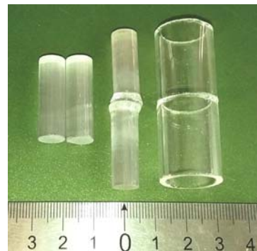
Рис. 4. Сваренные кварцевые детали
