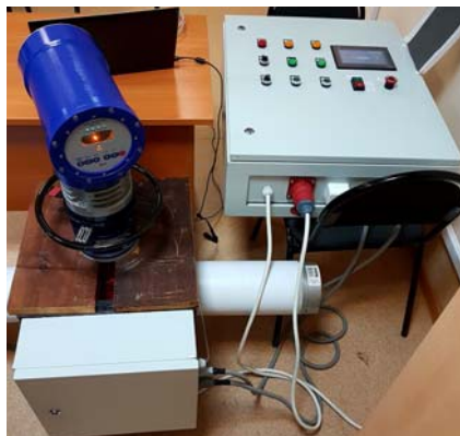
Рис. 2. Автоматизированная система контроля давления транспортируемого вещества в трубопроводе
